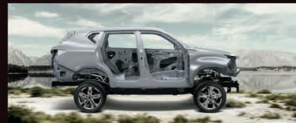
Carrocería reforzada con acero de alta resistencia en 81.7%
