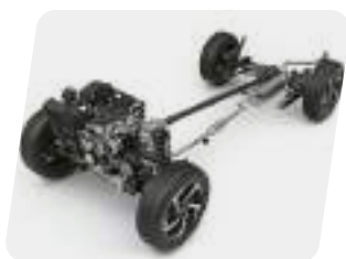
Disposición FR: motor adelante y tracción posterior
